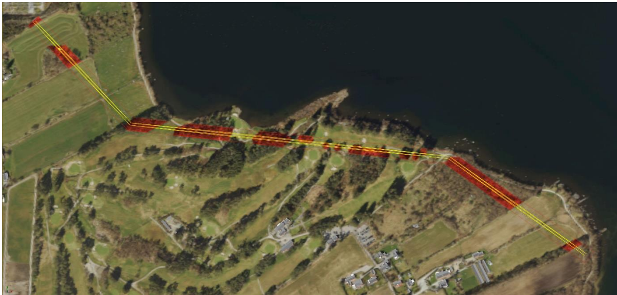
Figur 5.11. Ryddebelte langs luftledninger – vegetasjon markert med rødt må fjernes.
