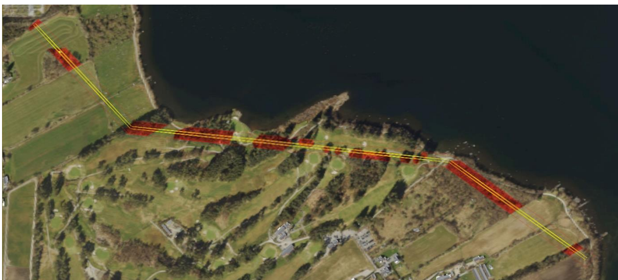
Figur 6.12. Fugleperspektiv over planlagt luftledningstrasé viser utstrekningen av rettighetsbeltet langs planlagt luftledning – vegetasjon (trær/skog) markert med rødt må fjernes.
