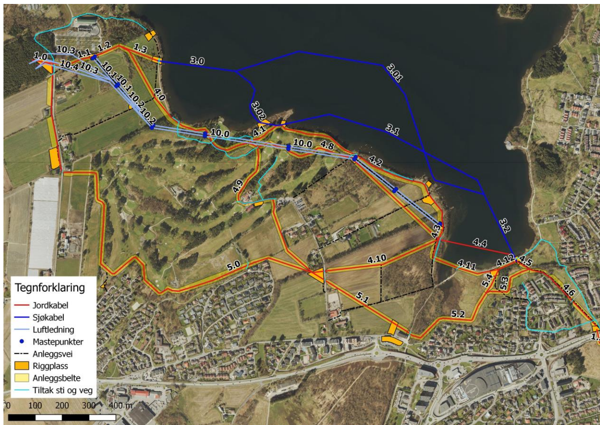
Figur 3.2. Nordlig del av tiltaket, mellom Tjensvoll og Stølaheia, med alle aktuelle traseer, samt anleggsbelte. Anleggsveier, midlertidige gang- og sykkelstier og riggplasser er kun forslag.
